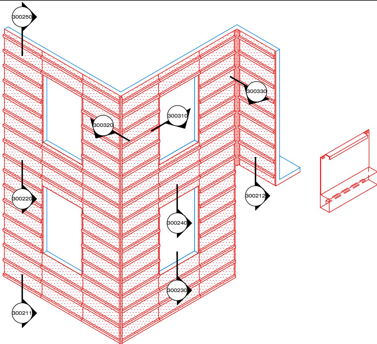
**Usage:** Panneau avec nervure en relief. Installation horizontale ou verticale.
